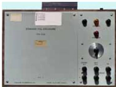
Conjunto de Weston Cell (pilas patrón saturadas)
